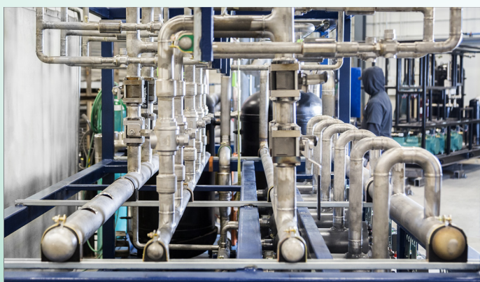
Nhóm van áp suất trung bình bằng thép không gỉ (1160 psi / 80 bar)
