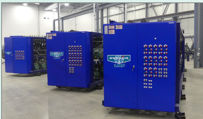
Bảng điều khiển bộ vi xử lý hiển thị Purity Rack
