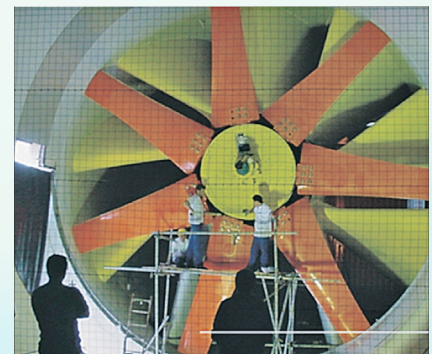
Cánh quạt cho đường hầm gió được điều khiển không dây
