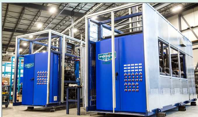
Purity Rack với vỏ bọc ngoài trời đang trong quá trình sản xuất
